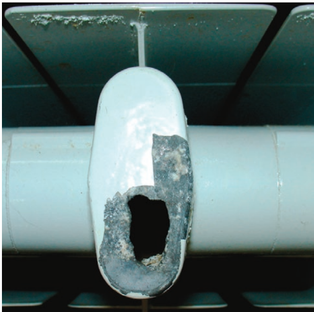
Рис. 2 Коррозия радиатора из алюминиевого сплава
