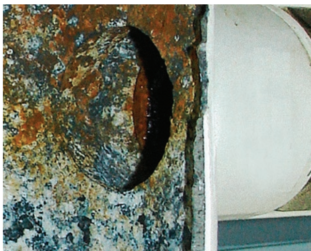
Рис. 5 Фрагмент секции радиатора из алюминиевого сплава, работавшего при повышенной щелочности теплоносителя
