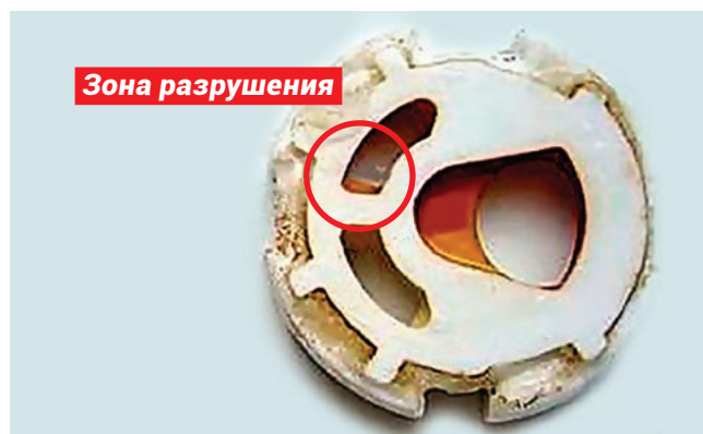
Рис. 11 Зона возможного разрушения керамической пластины смесителя
