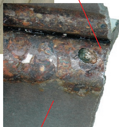
Рис. 1 Коррозия верхней части стального панельного радиатора
