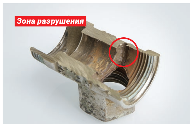
Рис. 13 Сквозное разрушение корпуса редуктора
